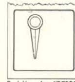
Posición de "DESCONECTADO": La manija queda en esta posición cuando el circuito está "abierto".
