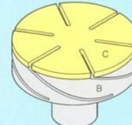
Aufbau eines Schaltstücks B: Kontaktträger C: Kontaktscheibe CrCu
