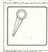
"RESTABLECER": Para restablecer el interruptor después de una desconexión, la manija se gira del centro a "restablecer".
