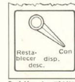
Posición de "CONECTADO": La manija en esta posición indica que el circuito está "cerrado".
