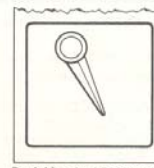
Posición de "DISPARO" (desconexión): Cuando el interruptor dispara automáticamente debido a una sobrecarga o corto-circuito.
